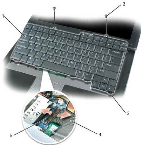
1 键盘 2 键盘螺钉 3 卡舌 (5) 4 键盘电缆 5 键盘连接器上的塑料条
